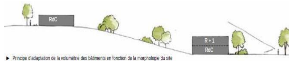
► Principe d'adaptation de la volumétrie des bâtiments en fonction de la morphologie du site
